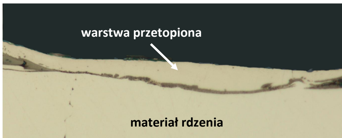
Rys. 9.1. Mikrostruktura warstwy wierzchniej po obróbce elektroerozyjnej
