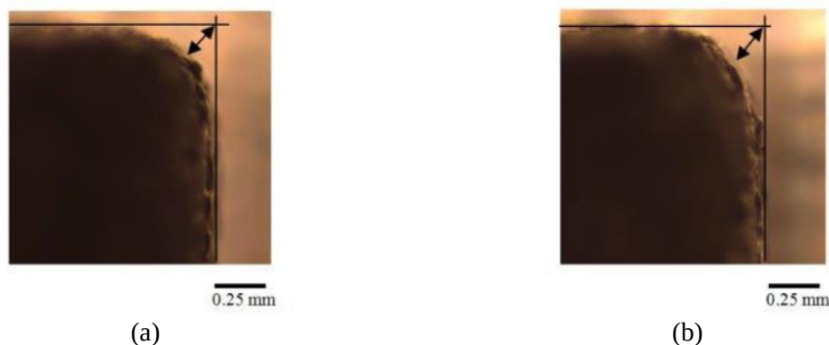
Rys. 2.39. Zużycie naroża elektrody roboczej po procesie EDM dla elektrody: a) EDM-3, b) EDM-C3 [123]
